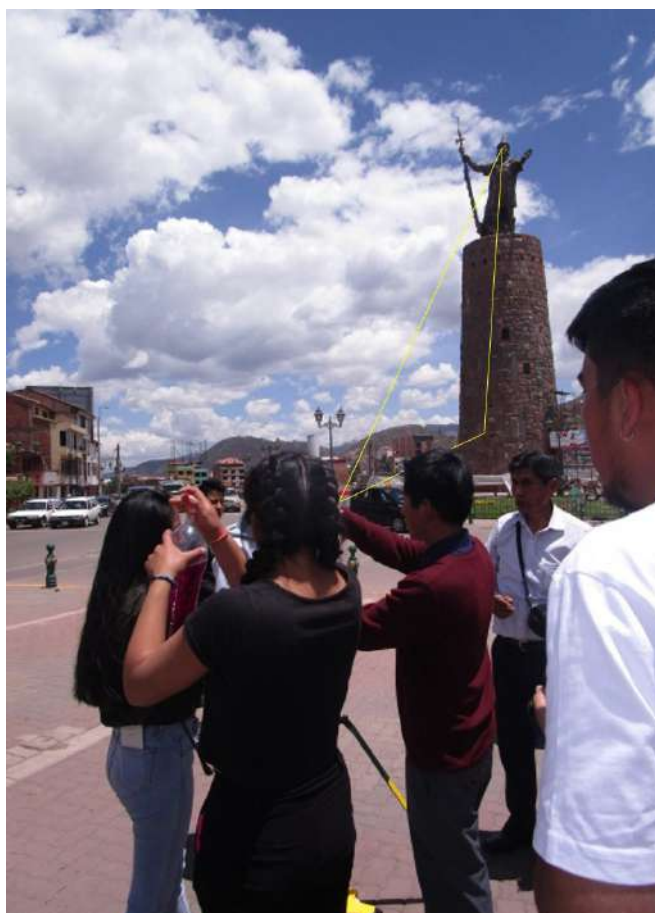
Estudiantes calculan la altura del monumento a Pachacútec utilizando el teodolito manual.
