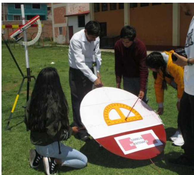
Círculo trigonométrico para calcular los valores de seno, coseno, tangente, cotangente, secante y cosecante de un ángulo.
